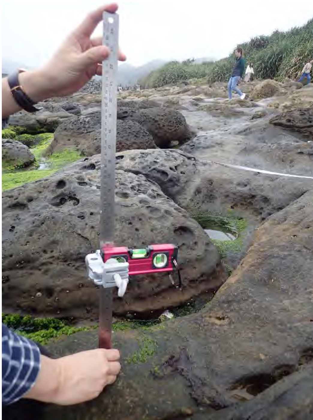
圖 3、由高潮線拉出第一條樣線後，利用水平尺測量垂直距離 25 公分為間格，依序往低潮位方向拉出下一條樣線(攝於東北角深澳岬之冬季採樣)。
