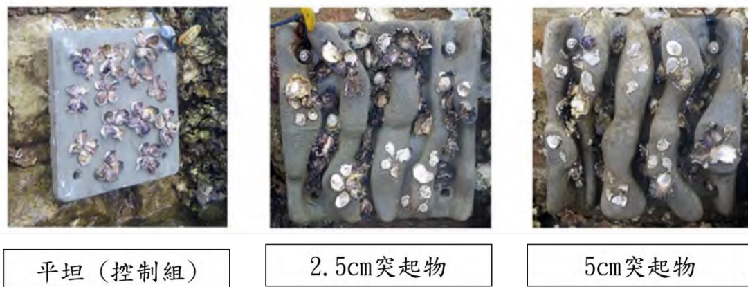
圖 12、不同突起物高度的海牆磚 (Strain et al., 2017)。
