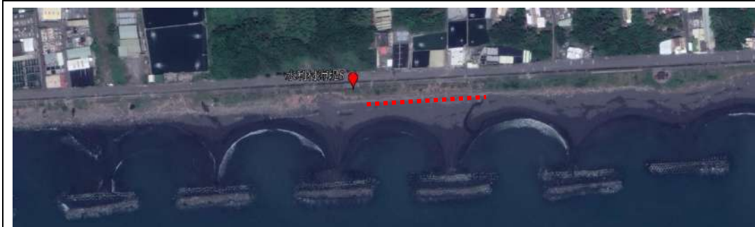
2018 年 10 月，部份消波塊被土砂覆蓋 (紅虛線示意)。
