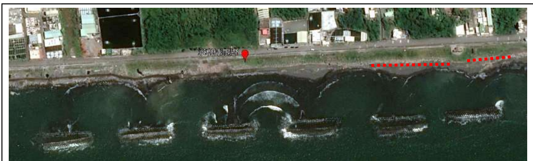
2017 年 9 月，部份消波塊被土砂覆蓋 (紅虛線示意)。
