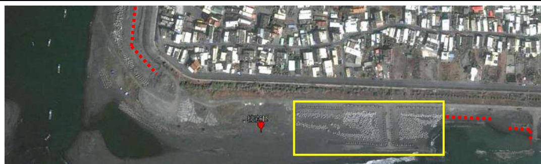
2013 年 2 月，新增消波塊 (黃線、黃框示意)，部份消波塊被土砂覆蓋 (紅虛線示意)。
