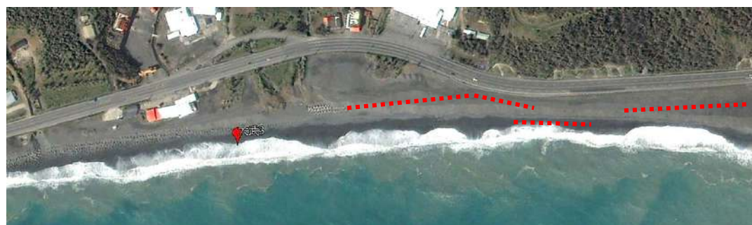
2013 年 2 月，消波塊被土砂覆蓋 (紅虛線示意)。
