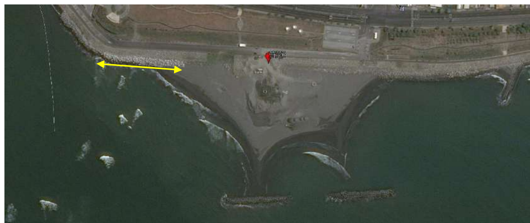
2013 年 11 月，海岸新增消波塊 (黃線示意)，沙岸因離岸堤的積沙作用，面積有增加的現象。
