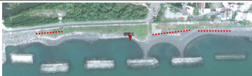
2012 年 11 月，部份消波塊被土砂覆蓋（紅虛線示意）。
