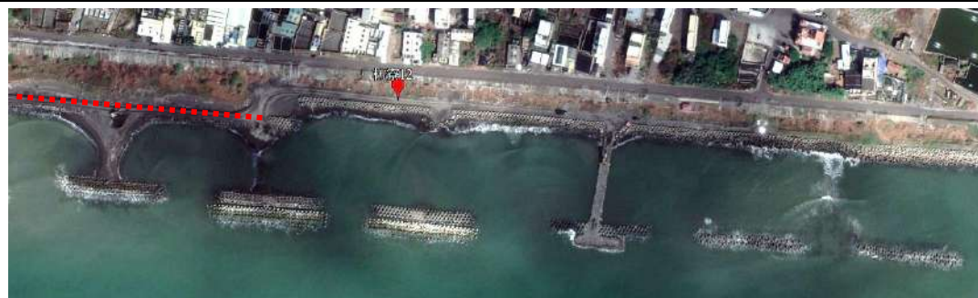
2019 年 1 月，部份消波塊被土砂覆蓋 (紅虛線示意)。
