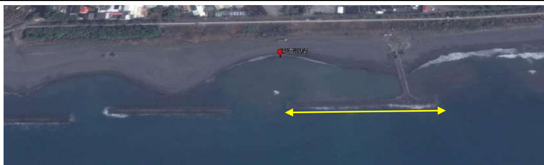
2014 年 12 月，海岸線右側新增離岸堤（黃線示意）。
