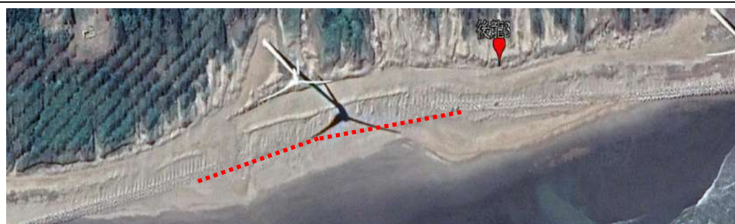
2017 年 12 月，沙埋嚴重，2013 年放置之消波塊被土沙覆蓋（紅虛線示意）。
