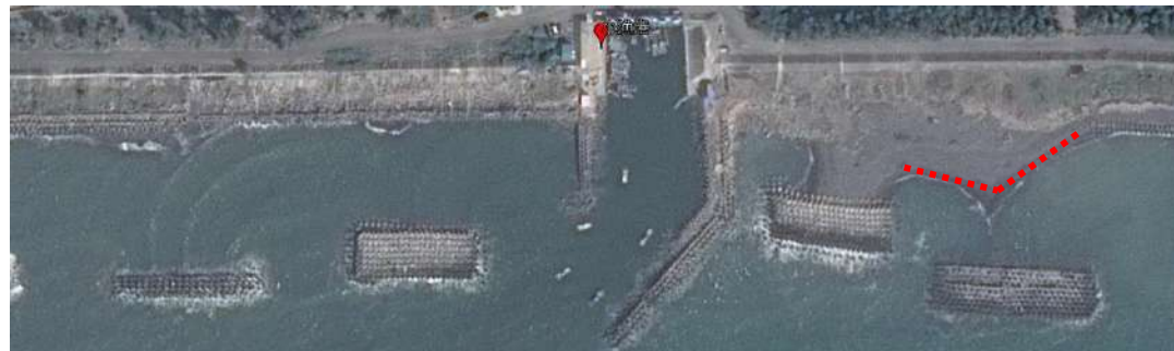
2014 年 1 月，部份消波塊被土砂覆蓋 (紅虛線示意)。
