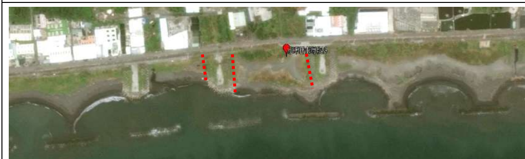
2017 年 7 月，部份消波塊被土砂覆蓋 (紅虛線示意)。
