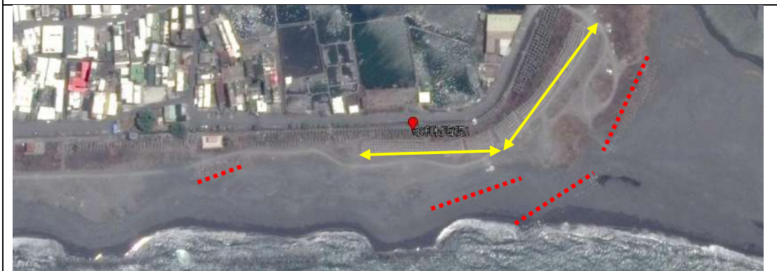
2015 年 4 月，新增消波塊 (黃線示意)，部份消波塊被土砂覆蓋 (紅虛線示意)。
