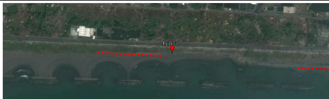
2017 年 1 月，部份消波塊已被土砂覆蓋 (紅虛線示意)。
