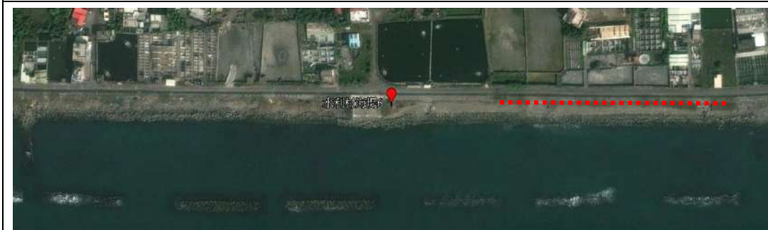
2017 年 1 月，部份消波塊被土砂覆蓋 (紅虛線示意)。
