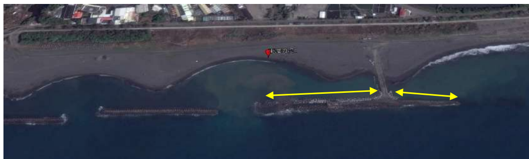
2015 年 1 月，右側離岸堤新投放消波塊（黃線示意）。
