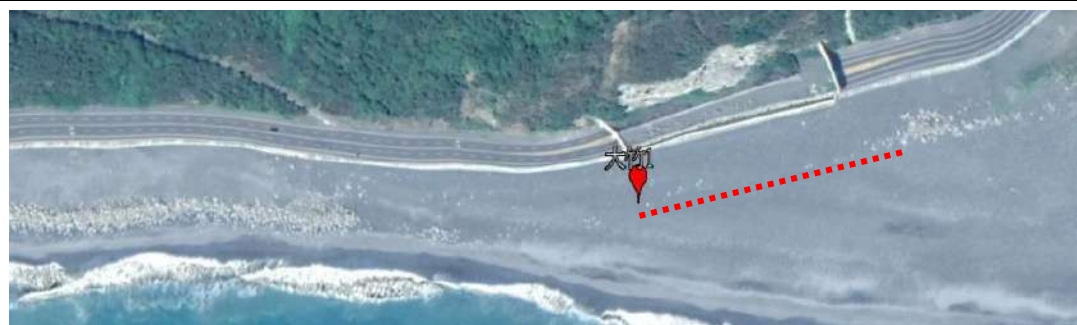
2018 年 12 月，部份消波塊被土砂覆蓋 (紅虛線示意)。
