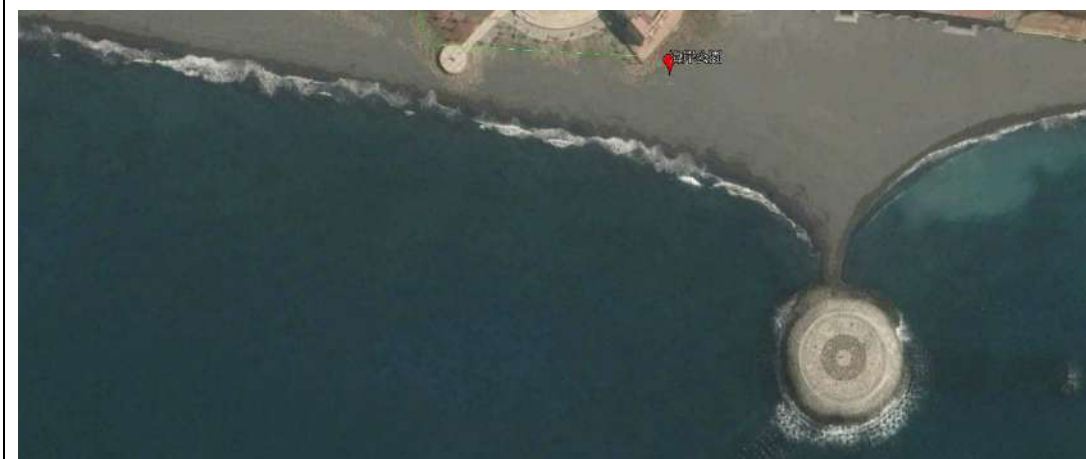
2015 年 2 月，工程完成，圓形區域以水泥與大型礫石組成，周圍有消波塊包圍。
