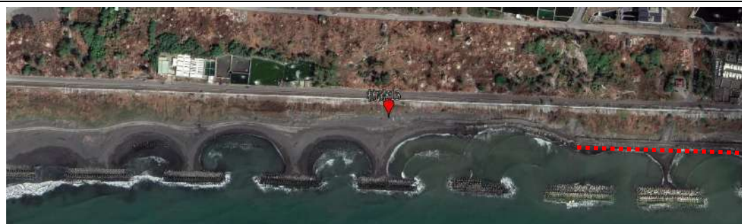
2019 年 1 月，部份消波塊已被土砂覆蓋 (紅虛線示意)。
