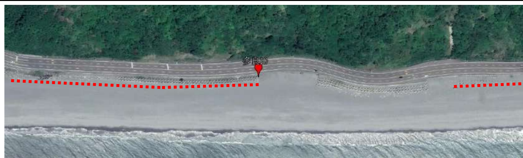
2020 年 5 月，Google Earth 最新圖像，可顯示目前紀錄最新的海岸線狀況。 部份區域有被土砂覆蓋（紅虛線示意）。
