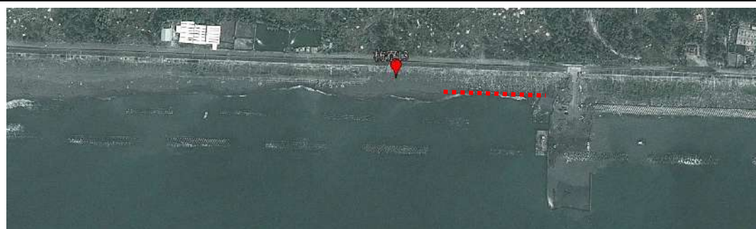
2013 年 1 月，部份消波塊已被土砂覆蓋 (紅虛線示意)。
