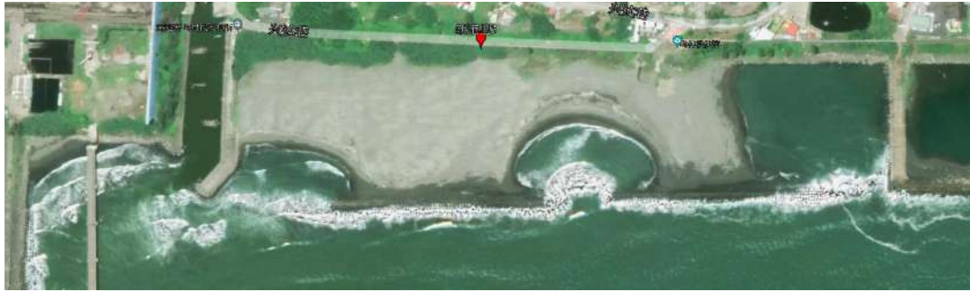
2020 年 7 月，Google Earth 最新圖像，可顯示目前紀錄最新的海岸線狀況。 放置離岸堤產生積沙現象，可見沙攤範圍較 2004 年時更擴展。
