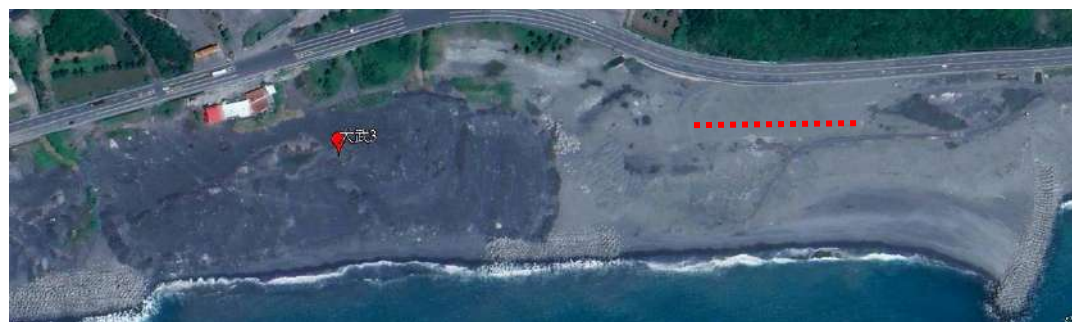
2017 年 8 月，部份消波塊被土砂覆蓋 (紅虛線示意)。
