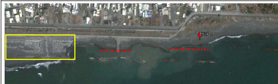
2013 年 2 月，新增消波塊 (黃框示意)，部份消波塊被土砂覆蓋 (紅虛線示意)。
