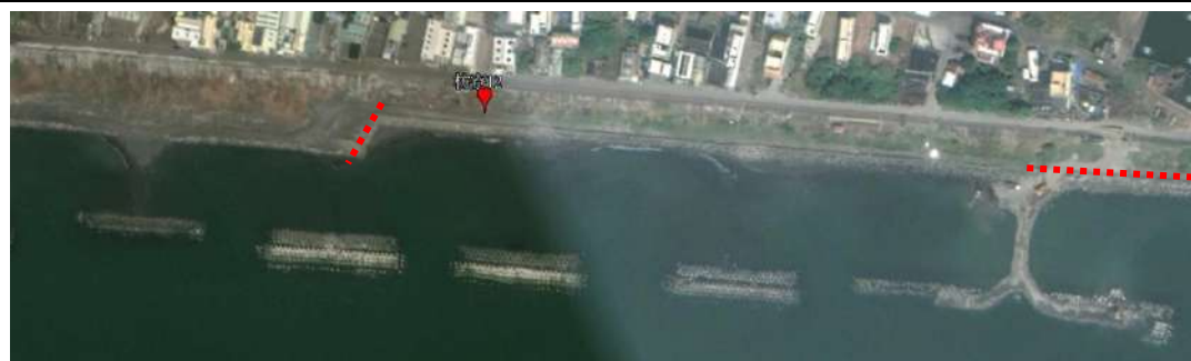
2019 年 10 月，部份消波塊被土砂覆蓋 (紅虛線示意)。
