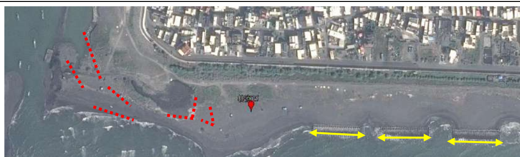
2014 年 1 月，新增消波塊 (黃線示意)，部份消波塊被土砂覆蓋 (紅虛線示意)。
