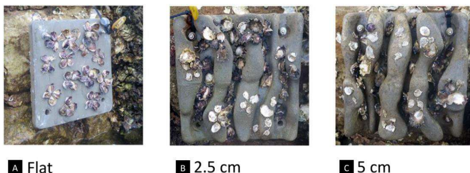
圖十、設計不同的海牆磚來測試對減輕魚類掠食團聚牡蠣 ( Saccostrea glomerata ) 的效果。包括：(A)、平坦無突起的對照組；(B)、具有 2.5 cm 突起物 (ridges) 的實驗組；(C)、具有 5 cm 突起物的實驗組。
