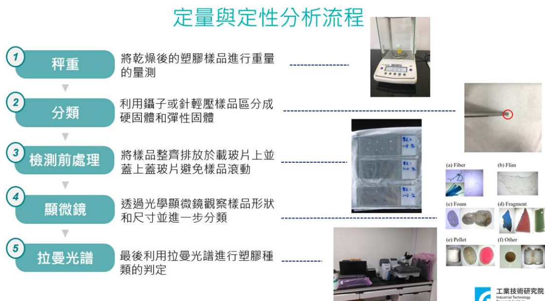
圖 3.2-28 海水樣品定量與定性分析流程
