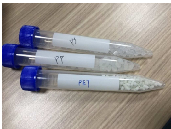
圖 3.2-13 PP, PS, PET 三種微型塑膠的標準樣品
