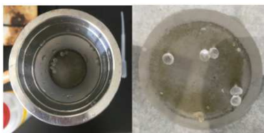
圖 3.2-22 抽器過濾裝置及過濾後的樣品
