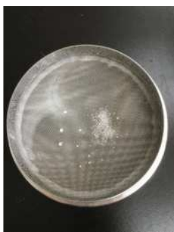
圖 3.2-18 測試所用的 PP 微型塑膠顆粒樣品
