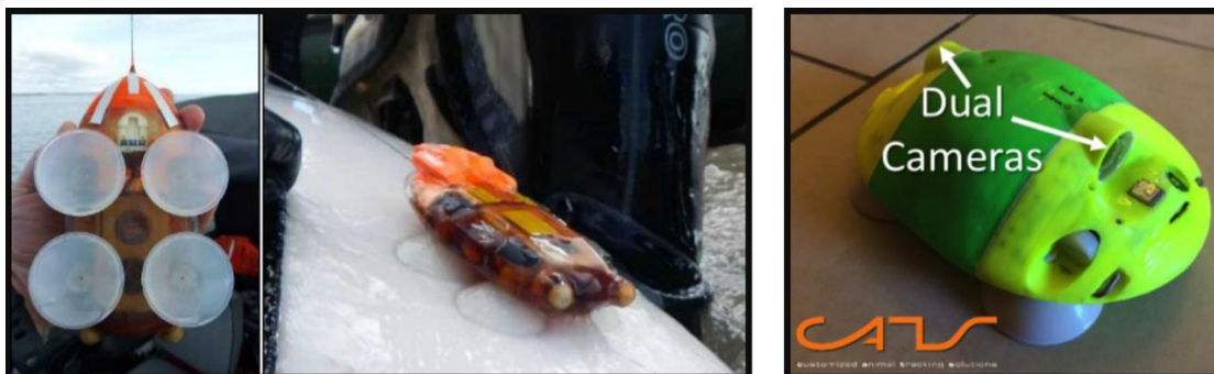
圖 2.3.1-1 吸盤式發報器，左圖為帶有聲學紀錄器的發報器、中圖附著於白鯨體表的狀態。右圖客製化發報器，具有雙攝影鏡頭、加速器、衛星定位系統、水溫、水深探頭，以及超高頻(VHF)傳輸器(National Marine Fisheries Service, 2019)。
