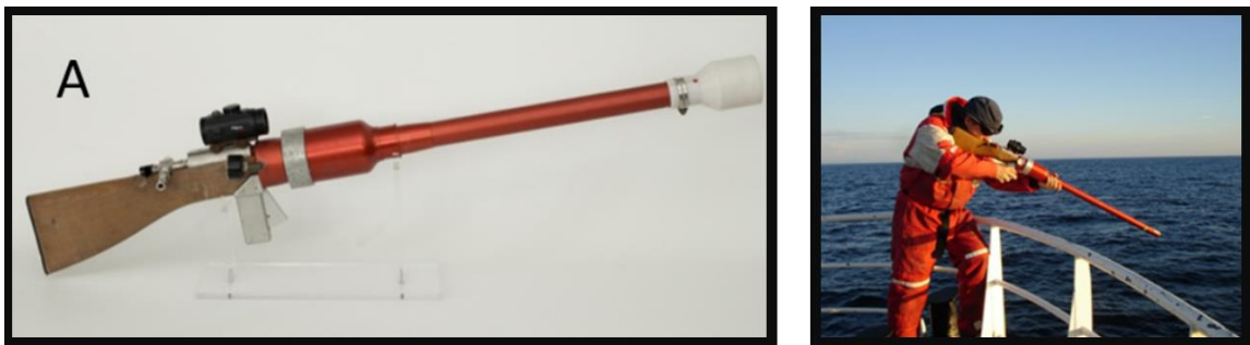
圖 2.3.1-7 氣動式來福槍和研究人員發射吸盤式發報器之示意照(Kleivane et al., 2022)。
