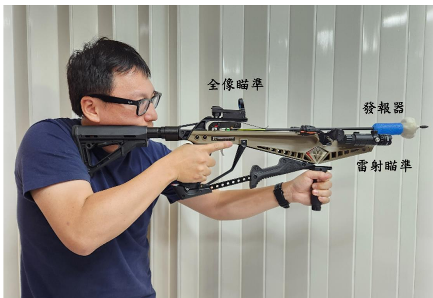
圖 3.1.3-21、十字弓完成安裝瞄準器、雷射瞄準與發報器。
