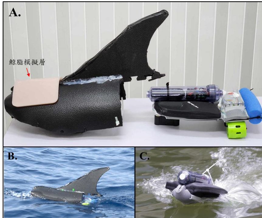
圖 3.1.3-15、海豚動力靶船可拆分為前端與後端，後端為動力機構。
