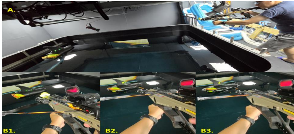
圖 3.1.3-25、室內演練場域(A.)與射擊測試影片擷圖，可成功錨定，並彈脫箭體(B1-B3)。
