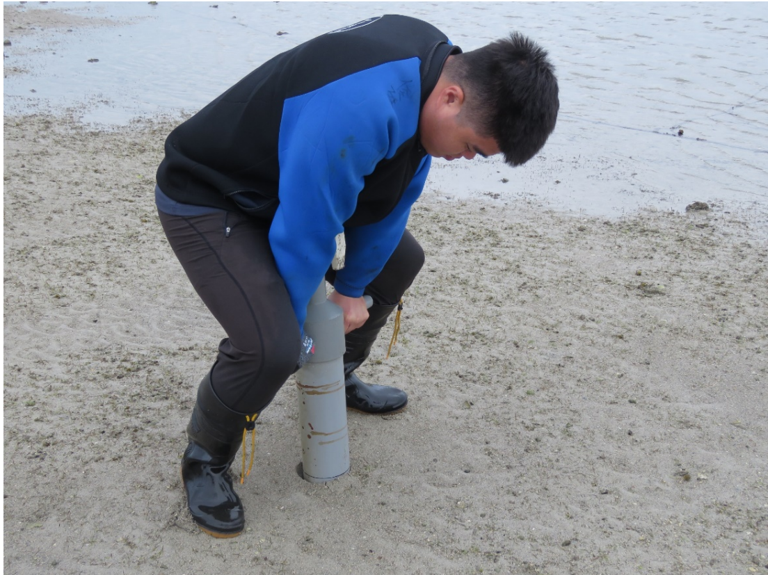
圖 19. 使用自製的 PVC 管採泥器進行底土採樣。
